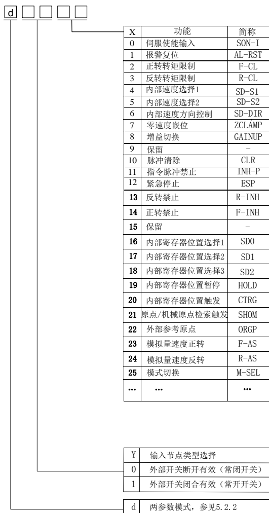
图 9.1.1 可编程输入端子功能设定示意图
