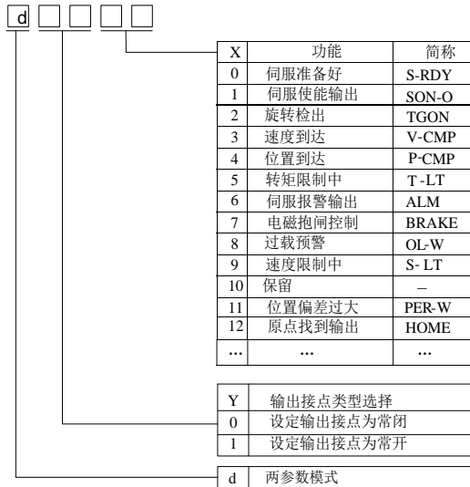
图 8.1.2 可编程输出端子功能设定示意图
